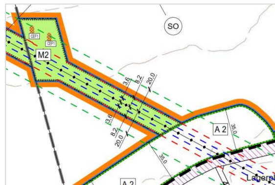
Abb. 13: Maßnahmenfläche M2 in BA 1 Bereich unter der Freileitung
